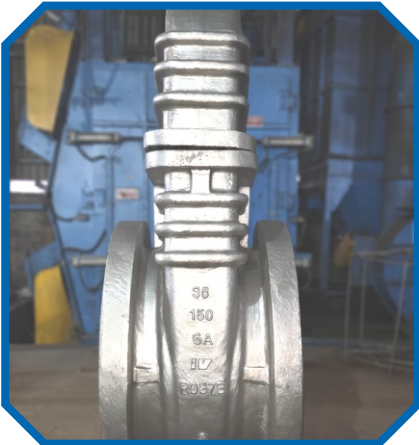
36" x 150 # GTV Body ASTM A 995 Gr. 6A
